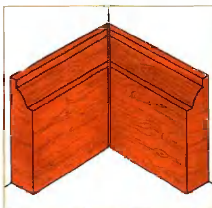
Высококачественная обшивка внутреннего угла достигается очень точной разметкой и тщательной подгонкой соединенных деталей плинтуса.
