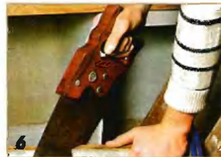
При искусном владении инструментом запилить «на ус» точно под заданным углом можно и без стусла.
